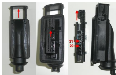
Obr.4 Demontáž konektoru – sloupek B
